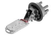
Адаптер кассеты КТ-3645 предназначен для установки кассеты КТ-3645 в муфту МВОТ-144. Внутри муфты МВОТ-144 можно установить до 6 сплайс-кассет КТ-3645 емкостью 36 волокон, тем самым получить максимальную емкость муфты МВОТ-144 до 216 волокон.
