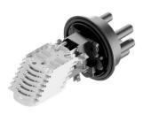
Предназначена для защиты мест сварки оптического кабеля и транзитной петли. Конструкция муфты МВОТ-144 позволяет сращивать несколько кабелей вместе, а расширенное внутреннее пространство позволяет уложить транзитные модули с соблюдением всех допусков. Температура эксплуатации от минус 60 °C до 70 °C.
