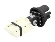
Предназначена для защиты мест сварки оптического кабеля и транзитной петли. Конструкция муфты МВОТ-144 позволяет сращивать несколько кабелей вместе, а расширенное внутреннее пространство позволяет уложить транзитные модули с соблюдением всех допусков. Температура эксплуатации от минус 60 °C до 70 °C.
