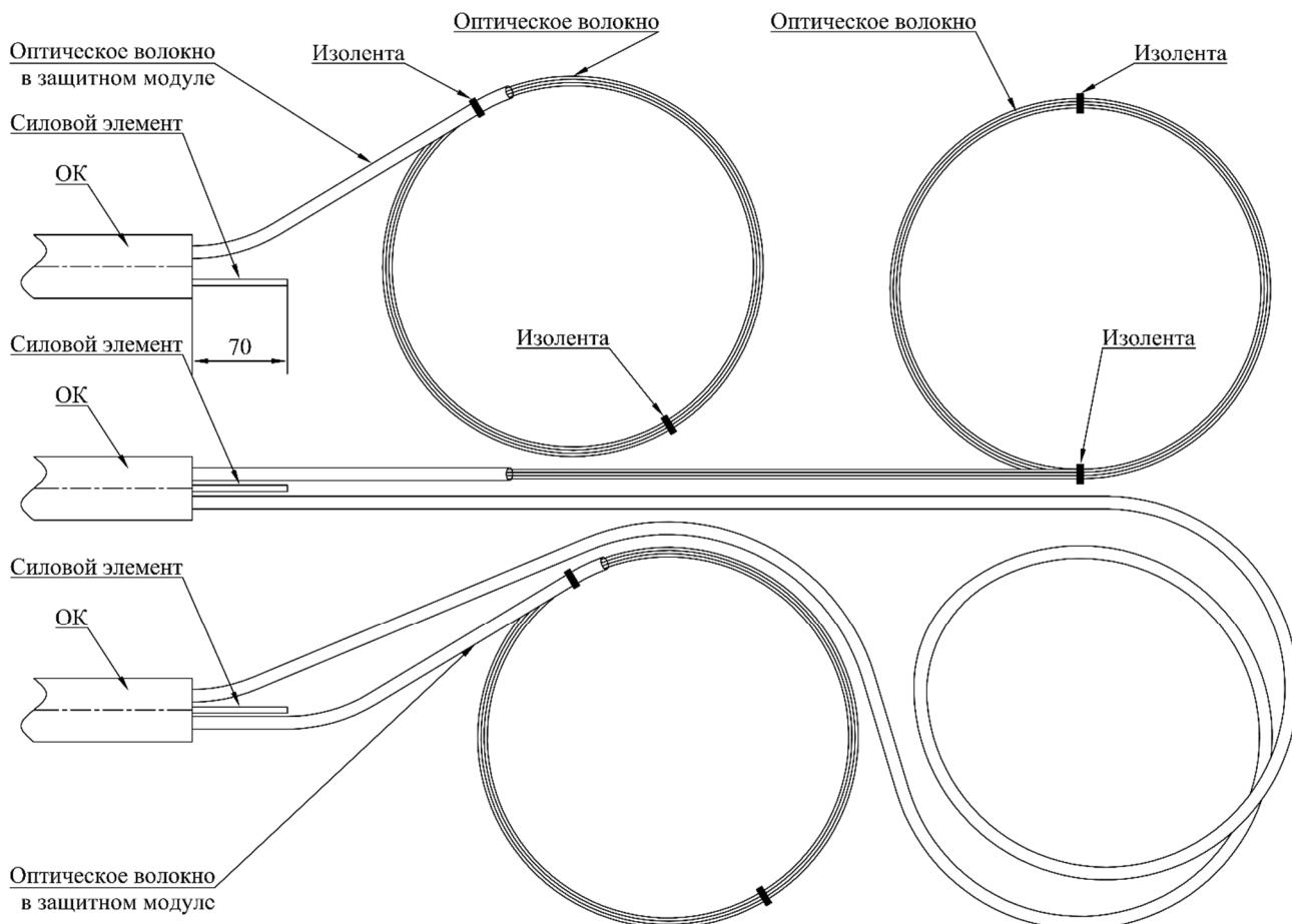
2.5. Закрепите ОК и силовой элемент ОК. При необходимости соедините экран или броню ОК с экраном муфты-кросс для обеспечения непрерывности соединения.
