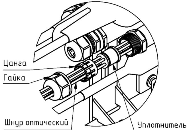
6.4. Подтяните оптический шнур на необходимое расстояние внутрь муфты-кросс, затем надвиньте на уплотнитель цангу и их вместе установите в корпус кабельного ввода.
