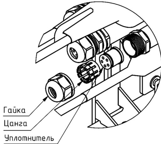
6.2. Разрежьте в уплотнителе нужное количество отверстий вдоль.
